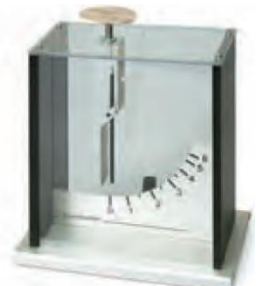
الف) تصویری از یک الکتروسکوپ درجه بندی شده بدون بار
