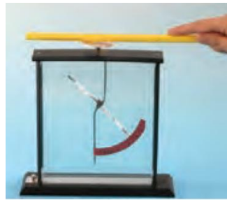
ب) جسی باردار را به کلاهک الکتروسکوپ بدون بار نزدیک کرده یا تماس داده ایم.
